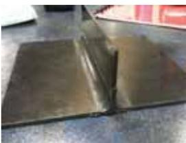
熱可塑性強化繊維複合材同士のウェルディング加工例(熱融着)
