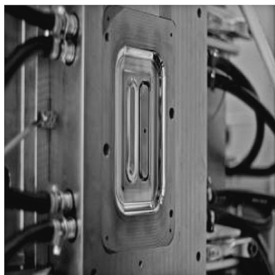
図9 ハイブリッド金型 (プラスチック/強化繊維複合材) による携帯端末カバー
