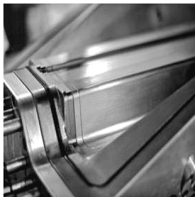
図 10 Post Curing が不要なハイスピード RTM 成形用電磁誘導金型
