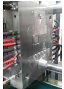
ロックツール誘導システムは、成形面の温度回復にかかる時間を大幅に短縮した。
